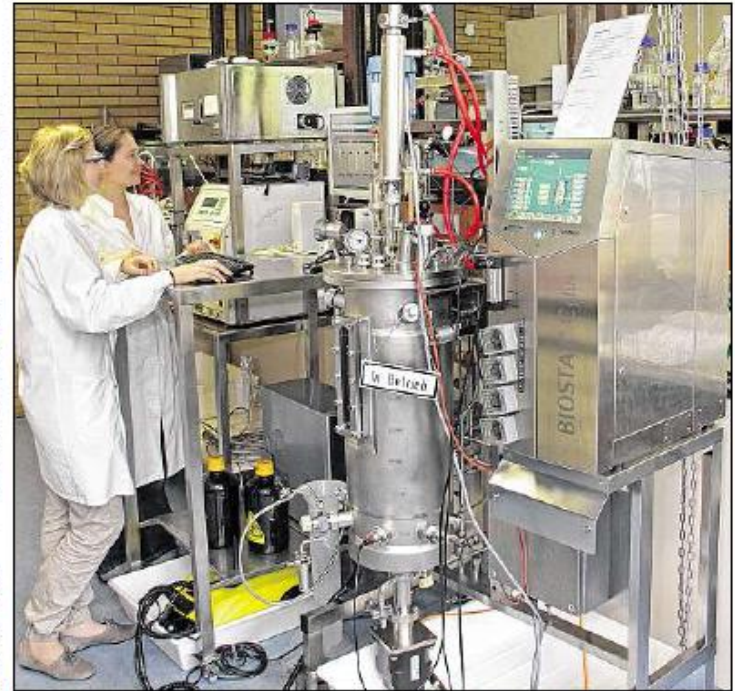
BRUTSTÄTTE: In diesem Bioreaktor können Bakterien gezüchtet und dann zur Produktion von Biotensiden angeregt werden. Julia Seiler und Michaela Zwick (von links) beobachten den Prozess. Foto: jodo
